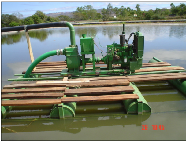
Figuras 11 – Balsa con bomba centrífuga para la extracción de lodos “vía húmeda”
