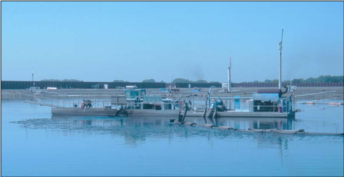
Fotos 7-6: Otros métodos de remover lodos de lagunas primarias incluyen bombeo con camiones de vacío, los cuales son típicamente utilizados para la limpieza del alcantarillado en ciudades grandes, y dragas flotando en una balsa (foto abajo). Los dos métodos requieren la construcción de lechos de secados para los lodos y manejo de lixiviados (Foto de arriba: León, Nicaragua; abajo: Ciudad de Sacramento, California).
