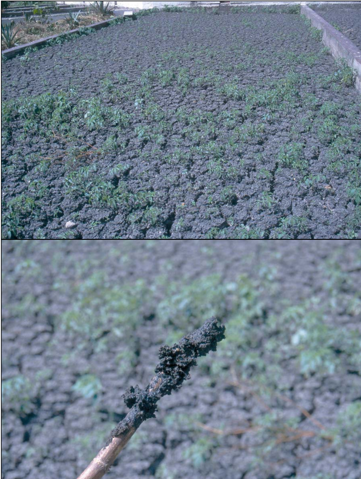
Fotos 7-1: Cuando los lodos empiezan a secar la capa superficial forman una capa dura que previene el secado de las capas inferiores como se ve en estas fotos de un lecho de secado. Mientras la capa superficial está seca (foto arriba), las capas inferiores mantienen su humedad como se ve después de meter un palo por adentro (foto de abajo). (Ciudad de Guatemala).
